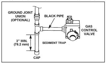
FIGURE 14. GAS PIPING WITH ALL BLACK IRON PIPE TO GAS CONTROL.
