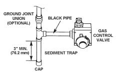
FIGURE 16. GAS PIPING WITH ALL BLACK IRON PIPE TO GAS CONTROL.
