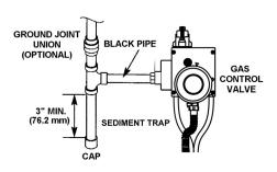
FIGURE 28. GAS PIPING WITH ALL BLACK IRON PIPE TO GAS CONTROL VALVE/THERMOSTAT
